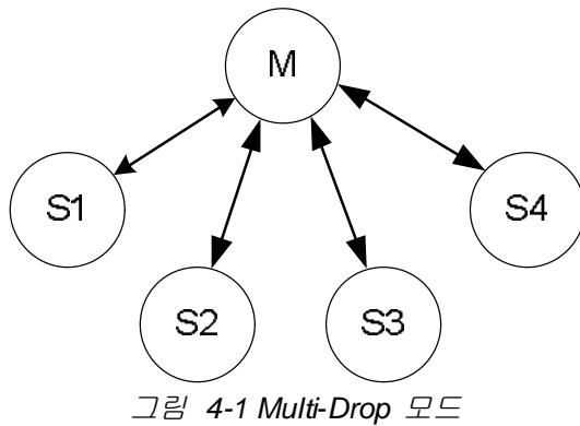
Multi-Drop 모드는 그림 4-1과 같이 1개의 마스터와 최대 4개의 슬레이브가 동시에 실시간으로 양 방향 통신을 수행합니다.
