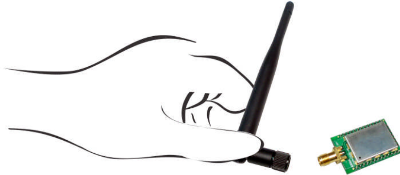
그림 2-2 RP-SMA 다이폴 안테나 설치
